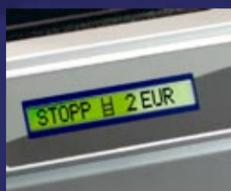
Wird während des Zähl- und Sortiervorgangs bei einer beliebigen Münzsorte der Soll-Wert erreicht stoppt die Maschine selbsttätig und zeigt die Sorte des jeweils vollen Behälters an. Nach dem Wechseln des Behälters wird der Vorgang über die Ein-Taste erneut gestartet.
